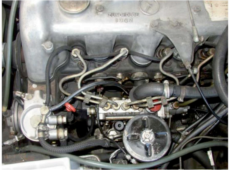
Eingebaute ESP bei einem 220D / OM 615. Dieser Wagen hat allerdings bereits den Dieselhauptfilter des späteren W123
