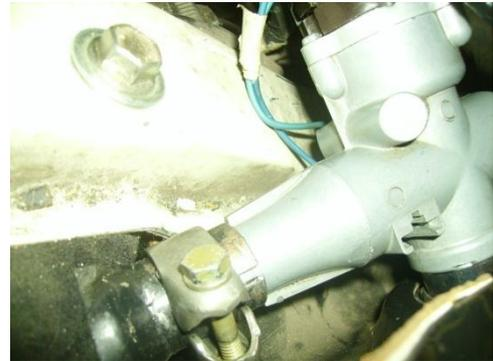
Das Zündschloss des /8 kann nur mit einem passenden Schlüssel ein- und ausgebaut werden. Um dran zu kommen, wird erst das Kombiinstrument ausgebaut (vorziehen, Tachowelle abschrauben, 2 Lichtleitungen rausziehen, Zentralstecker abziehen, Öldruckanzeige abschrauben, bei Automatik Drahtzug aushängen).
