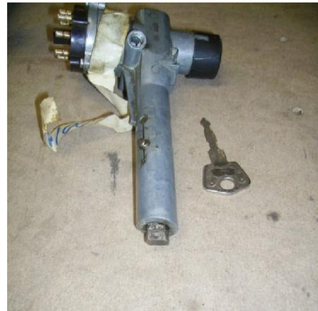
2. Alle Schlösser haben am Ende des Rohrs einen Vierkantstift als **Lenkradschloss**. Diese Vierkant fährt aus, wenn man den Schlüssel abzieht. Er rastet dann in ein entsprechendes Loch in der Lenksäule ein.
