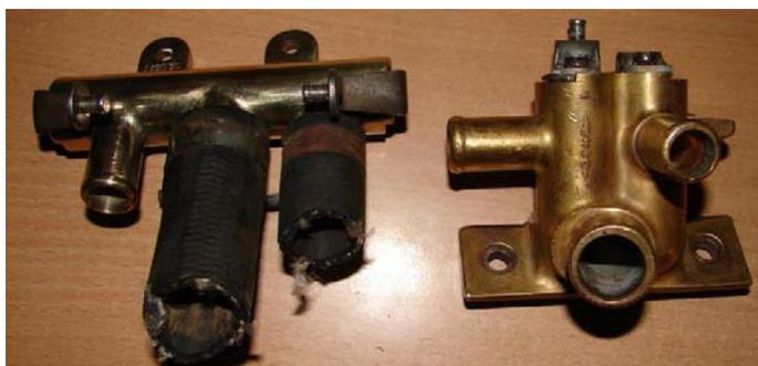
Unterscheidung Heizungsventile: Links zweite Serie, rechts und Fotos oben erste Serie
