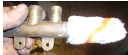
Für den Wiederaufbau werden die Gummis erneuert. Der kleine Gummi hat die Besonderheit einer eckigen Aussenform, und deshalb nicht so einfach im Zubehör zu beschaffen. Der große Aussengummi ist ein ganz normaler runder Gummiring mit einem Innendurchmesser von 12mm. Diesen kann man also leicht auch preiswerter woanders beschaffen.
