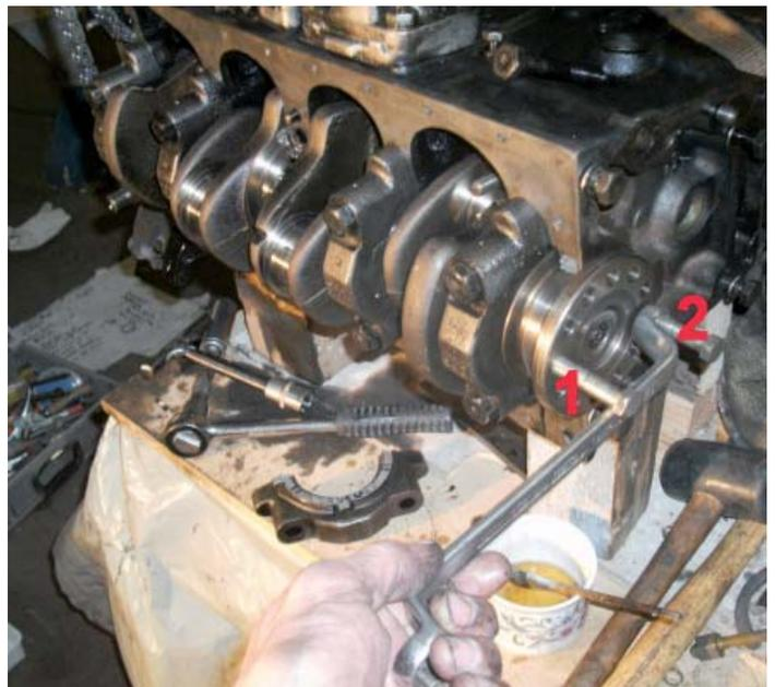
Mit zwei passenden langen Schrauben (1 u. 2) und einem Schraubenschlüssel kann man die Kurbelwelle problemlos drehen.
