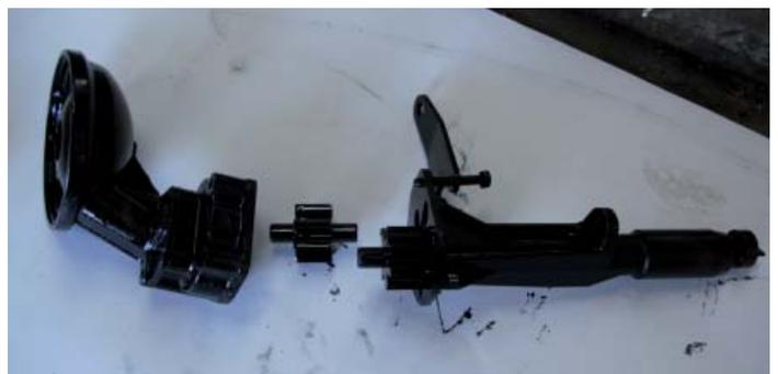
Die zerlegte Ölpumpe (vor der Reinigung)
