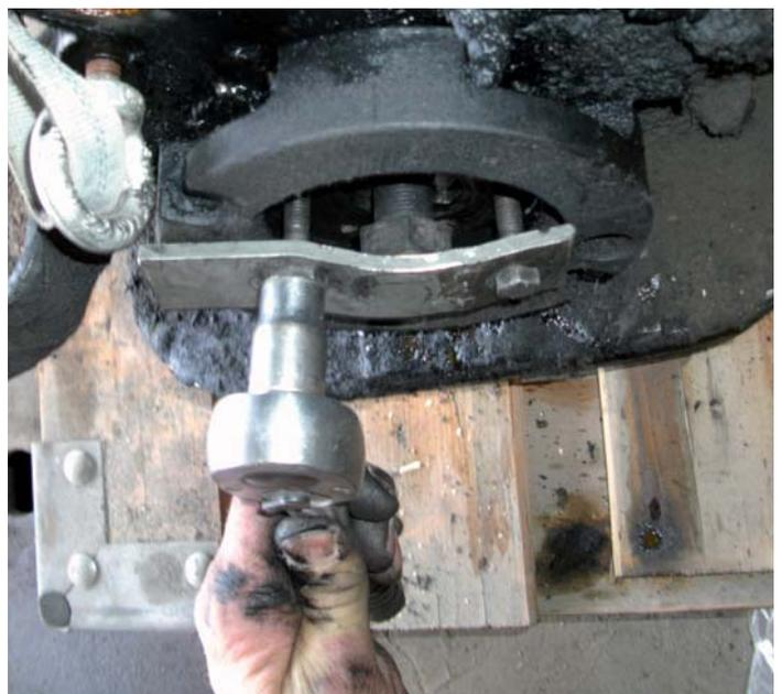
Selbst angefertigter Abzieher für die vordere Schwungscheibe
