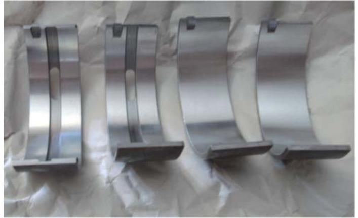
Beispiel für neue Lagerschalen. Man erkennt deutlich die Passnasen und Ölkanäle und -bohrungen.
