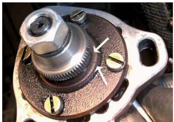
ESP Einbau: beide Markierung zur Deckung bringen
