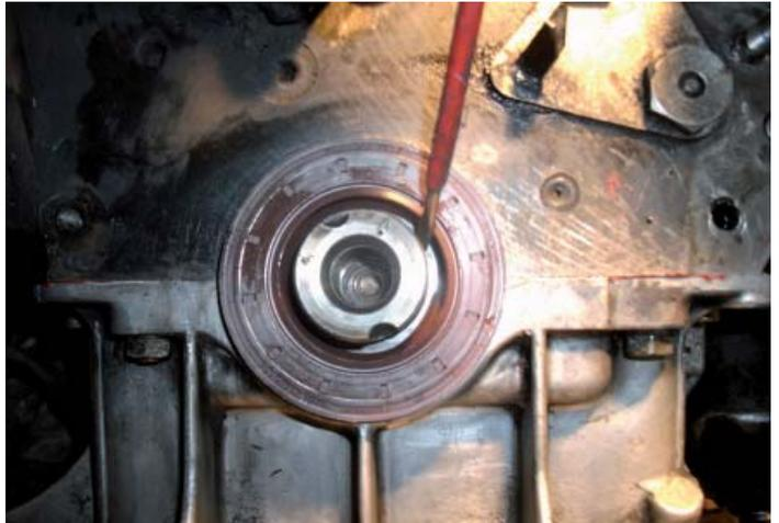
Der eingeölte Ring wird gefühlvoll eingesetzt.
