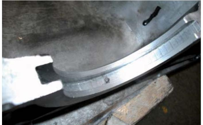
Die obere Ölwanne und die Nut in die die Dichtung gehört. Mittig sieht man einen Dorn der verhindert, dass die Dichtung seitlich verrutschen kann.
