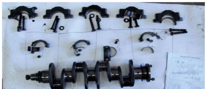
Die Beute: Die Lagerschalen, -blöcke und Schrauben sind auf einer nummerierten Pappe sortiert gelagert, damit sie beim Wiedereinbau wieder eindeutig zugeordnet werden können...
