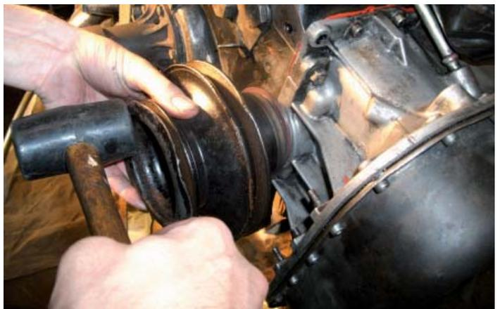
Mit einer alten Keilriemenscheibe wird er passgenau festgekopft.
