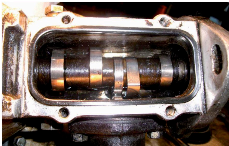
Blick von unten auf eine offene ESP mit der Nockenwelle
