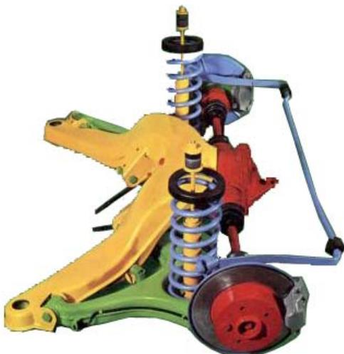
Die „Diagonallpendelachse“ und ist technisch eine „Schräglenkernachse“.
