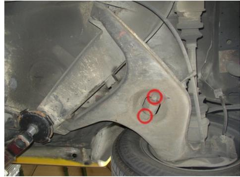
6. **Untere Stoßdämpferbefestigung lösen** (Im Bild „D“). Die zwei SW17 Schrauben raus drehen. Diese können biestig festsitzen (siehe auch Hinweise)! Stoßdämpfer nach unten raus ziehen.
