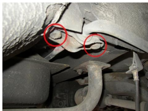
7. **Drehstab wieder montieren** (Im Bild „C“), (zwei SW17 Schrauben).
