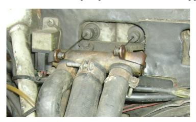
Dazu muss das komplette Reglerventil ausgebaut werden. Das geschieht, indem
