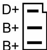
Den Stecker an der Lima abziehen und am D+ Kontakt obige Tests 1) und 2) durchführen
