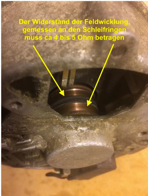
Dazu Test nach dem Text im Foto machen. Wenn die Läuferwicklung defekt/unterbrochen ist, besteht kein Durchgang.
