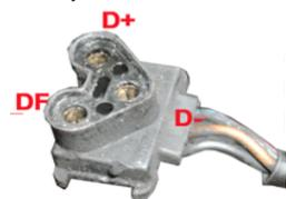
Als Erstes den Stecker an der Lima abziehen und am D+ Kontakt obige Tests 1) und 2) durchführen.
