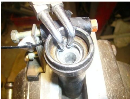
Der Sprengring wird mit einer Zange entfernt. Die Feder wird in die Ösen des Kolbens gedreht. Der neue Gummi für den Zulauf des Geberzylinders (Das dicke Ende kommt nach unten)
