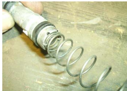
Der Sprengring wird mit einer Zange entfernt. Die Feder wird in die Ösen des Kolbens gedreht. Der neue Gummi für den Zulauf des Geberzylinders (Das dicke Ende kommt nach unten)
