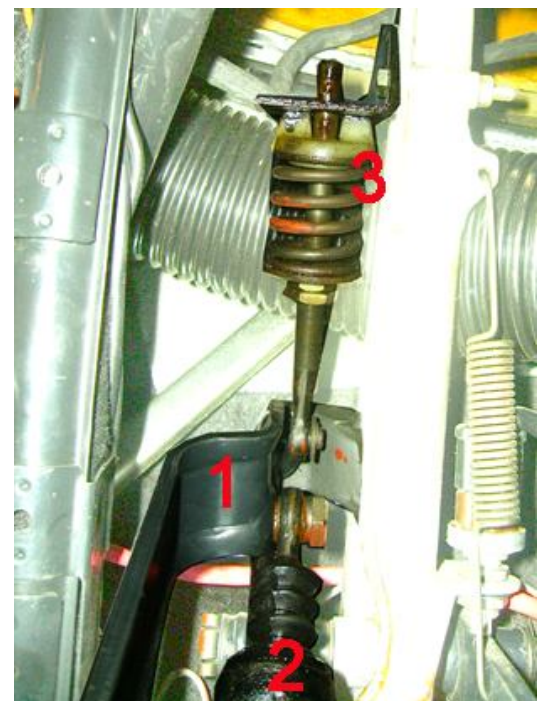
Einstellmechanismus am Kupplungspedal: 1 Pedal, 2 Geberzylinder, 3 Übertotpunktfeder )
