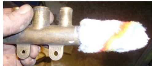
Für den Wiederaufbau werden die Gummis erneuert. Der kleine Gummi hat die Besonderheit einer eckigen Aussenform, und deshalb nicht so einfach im Zubehör zu beschaffen. Der große Außengummi ist ein ganz normaler runder Gummiring mit einem Innendurchmesser von 12mm. Diesen kann man also leicht auch preiswerter woanders beschaffen.
