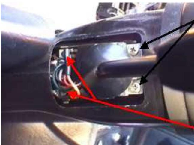
Zum Lösen der Schaltermechanik die beiden Kreuzschlitzschrauben (schwarz) öffnen.
