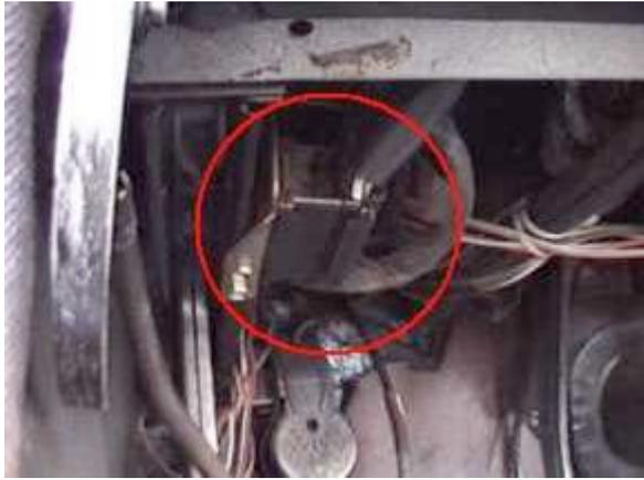
Um den Schalter herausziehen zu können, muss der Anschlussstecker abgesteckt werden. Dieser befindet sich unterhalb des Armaturenbretts rechts neben dem Motorhaubenzuges (ziemlich dickes Kabel dran!). Wenn man den Blinkerhebel komplett ausbauen möchte, dann muss man ziemlich fummeln, dass man den Stecker durch die Lenksäule durchbekommt; ansonsten würde ich die Reparatur vor Ort vornehmen (die Länge des Kabels vom Anschluss bis zur Lenksäule reicht allemal!
