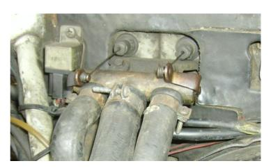
Für die Reparatur muss das Reglerventil komplett ausgebaut werden. Das geschieht, indem
