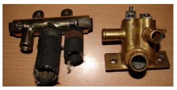
Unterscheidung Heizungsventile: Links zweite Serie, rechts und Fotos oben erste Serie
