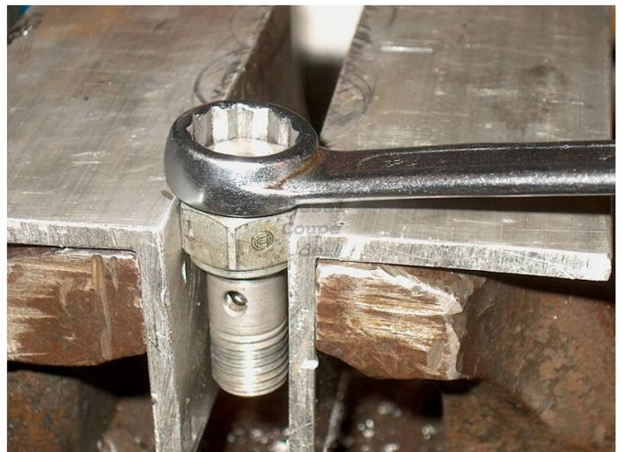
Ist die Verschlusschraube gelöst, das Überströmventil aus dem Schraubstock nehmen und über der Arbeitsplatte, idealerweise in einer kleinen Schüssel o.ä. zerlegen, die Feder hat zwar nicht viel Spannung, aber Federn springen immer gerne weg und während man der Feder nachschaut, fällt die Kugel raus und kullert davon.
