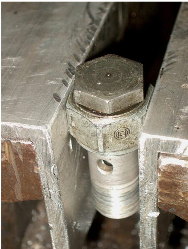
Dann mit dem 14er Ringschlüssel die Verschlussschraube lösen, manchmal geht's leicht, manchmal muß man recht kräftig zupacken. Die Schraube nur lösen, nicht entfernen!
