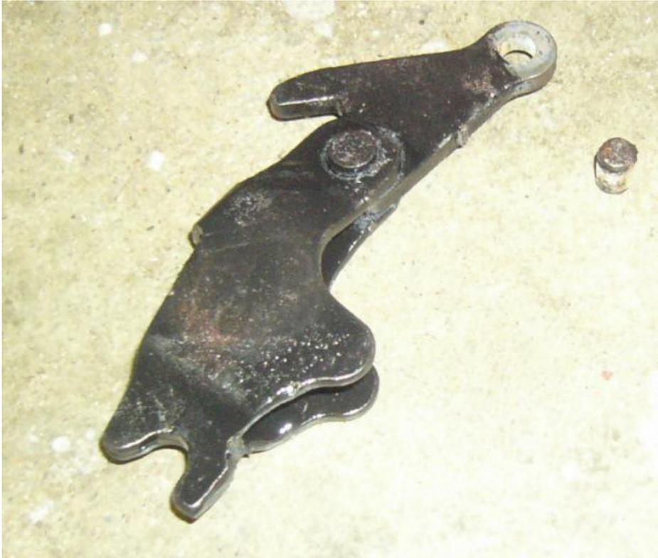
*Der Stift für den Seilzug muß aus dem Umlenkhebel gedrückt werden.*
