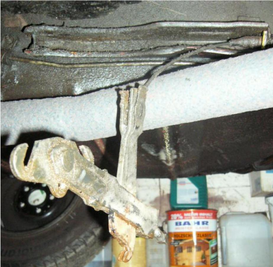
*Umlenkhebel entspannt und aus der Führungsschiene ausgehackt.*
