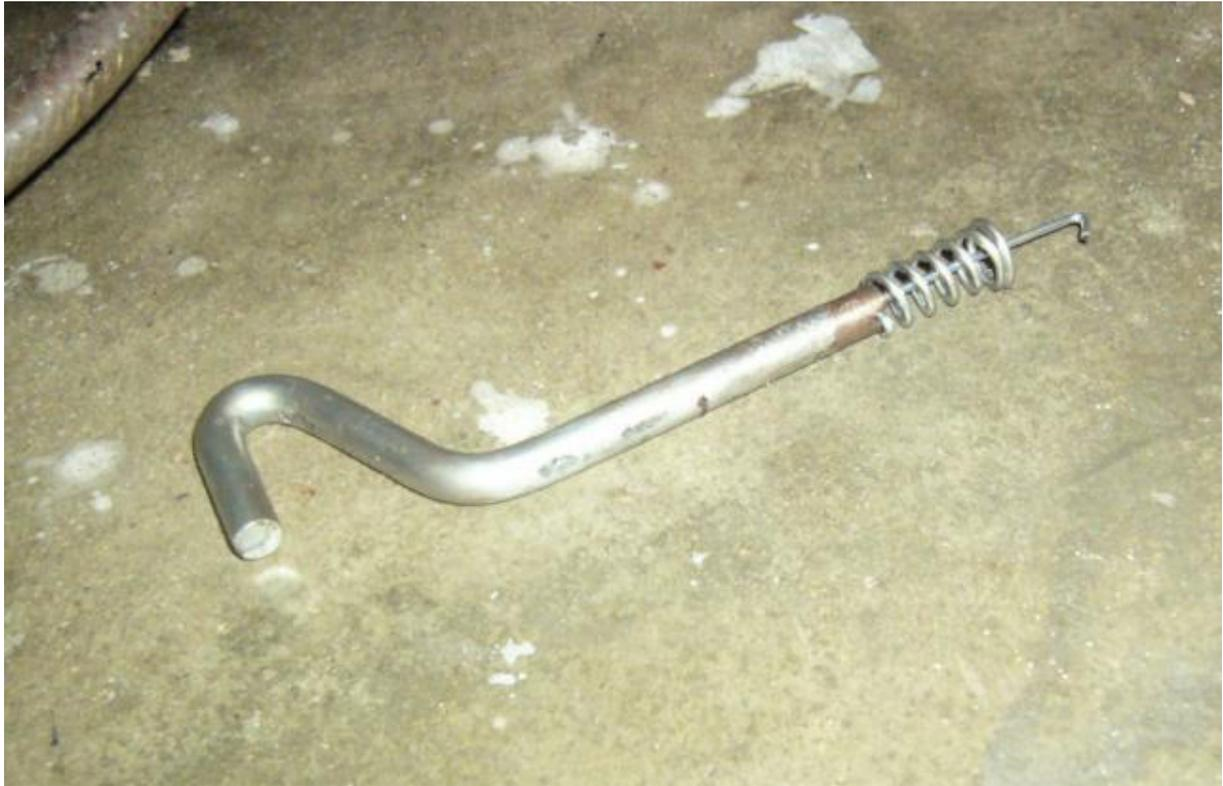
*Selbstgebauter Montagehebel um die Bremsbackenhaltefedern mit einer 90°-Drehung festzusetzen.*
