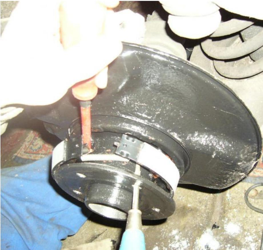
*Bremsbacken auseinander drücken, ein Backe fixieren (blau) und die andere abhebeln (rot) Spanner einsetzen/entfernen.*
