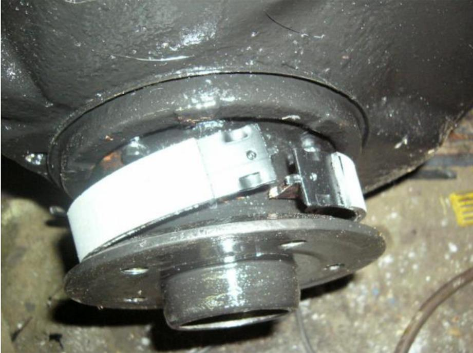
*Bremstrommel ohne Spanner und Haltefedern. Alle Federn eingehackt.*
