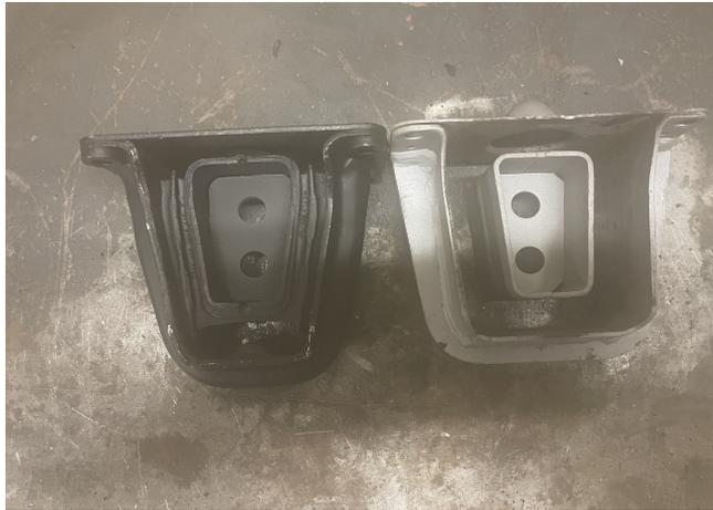
Links das schwarze nur noch erhältliche A1233511142 (Meyle 014 035 0016) und zum Vergleich rechts das sandgestrahlte, zum Umbau vorbereitete Altteil A1153512542. Man sieht, dass das 123er Lager unten länger ist und somit an die Kühlrippen des Differenzials stößt.
