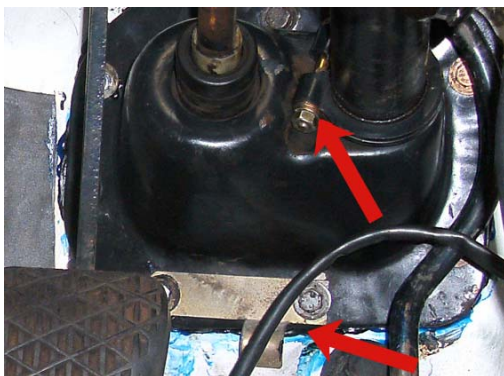
Bild: Abdeckung im Fußraum. Durch Lösen der Schelle (Pfeil oben), kann diese Abdeckung später verschoben werden. Unten sieht man die mit zwei Schrauben befestigte messingfarbene Halteschelle für die (hier nicht vorhandene) Tachowelle.
