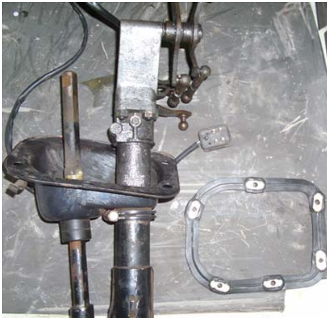
Bild: In die Dichtung sind Metallplättchen mit Gewinde geklemmt.
