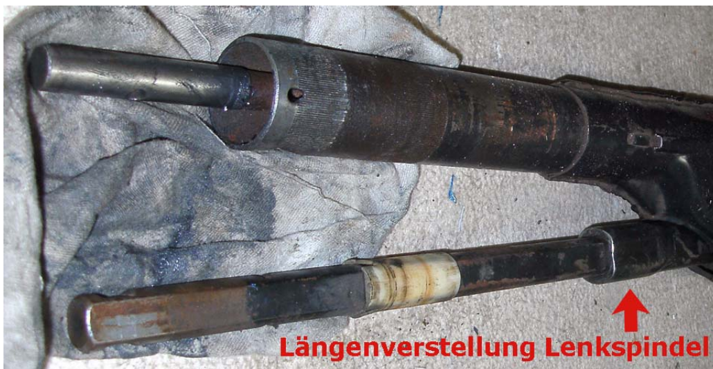
Bild: Abgenommener Schaltblock und Hinweis auf Längenverstellung der Lenkspindel
