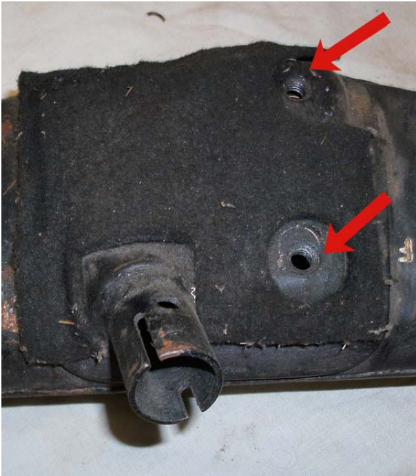
Bild: Obere Befestigungspunkte der Lenksäule und Rohr für Lenkradschloss mit Stiftloch
