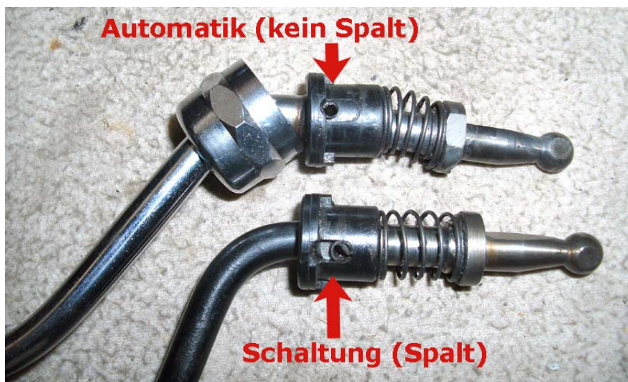
Bild: Ist es auch der richtige Schalthebel? Es gibt unterschiedliche Ausführungen bei Automatik und Schaltgetriebe. Beim Schaltwagen kann man den Kunststoffring verschieben, dahinter verbirgt sich die Rückwärtsgangsperr.
