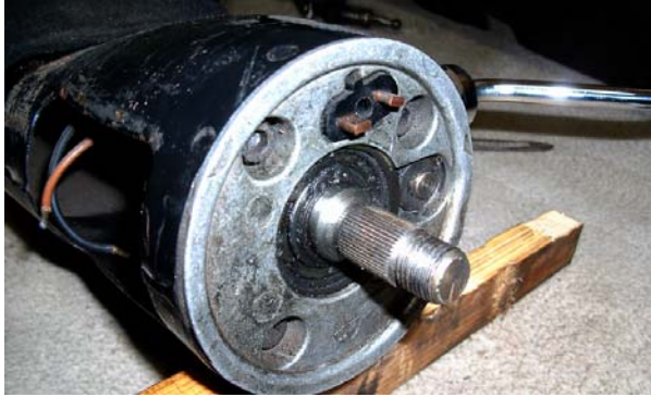
Bild: Lenkrad ist abgenommen, Kombischalter demontiert
