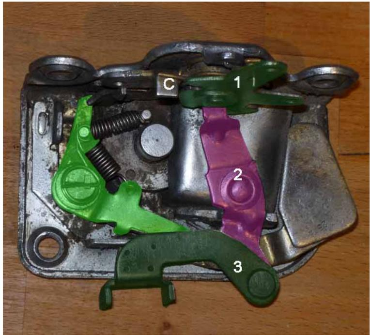
Innenverriegelung: Durch Niederdrücken des schwarzen Knopfs wird die Türe verriegelt. Teil 1 verdreht sich nach links. Gleichzeitig rastet Haken C ein.
