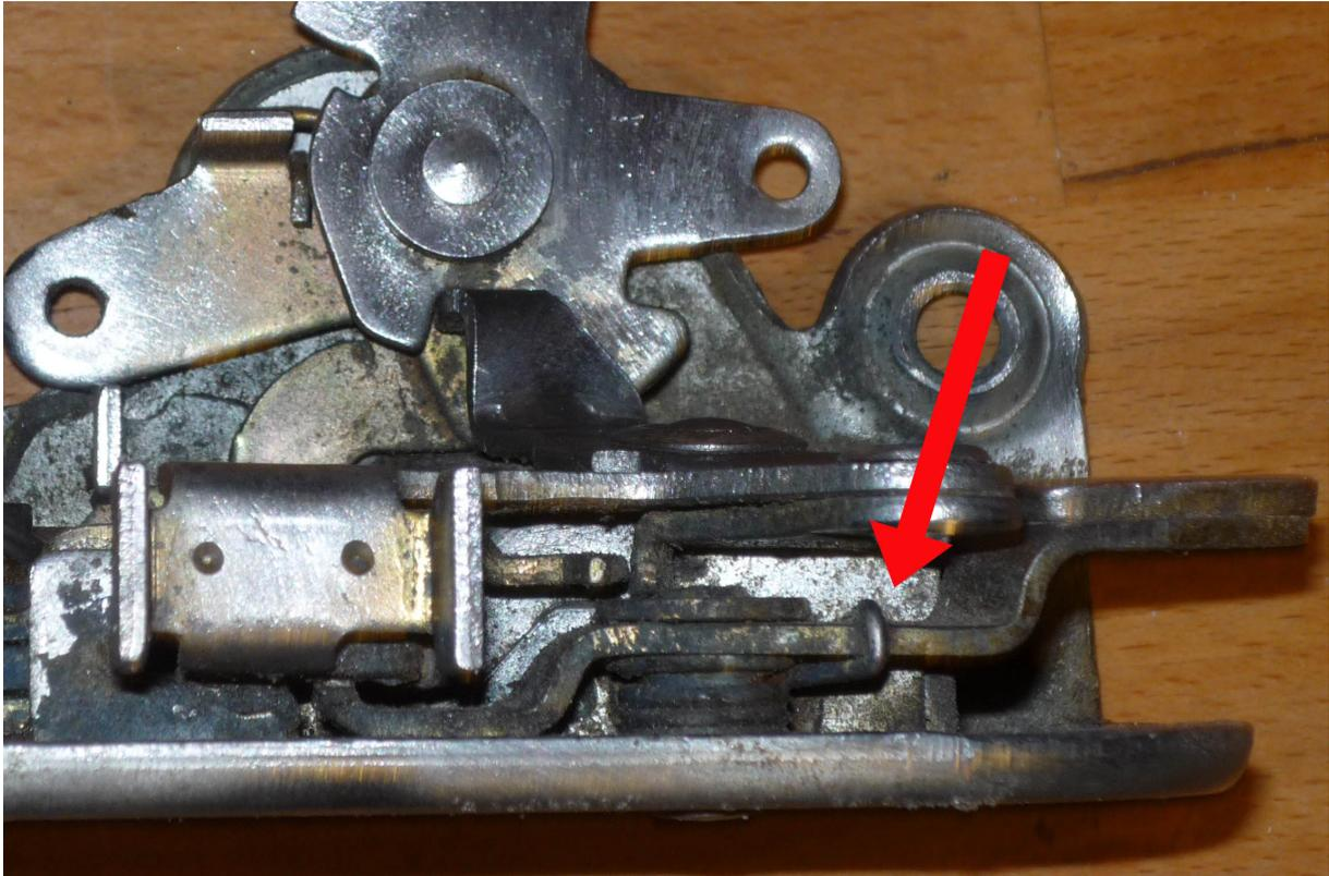
Starke Feder am Hebel für die Schließung von innen (vernietet, also nicht demontierbar):
