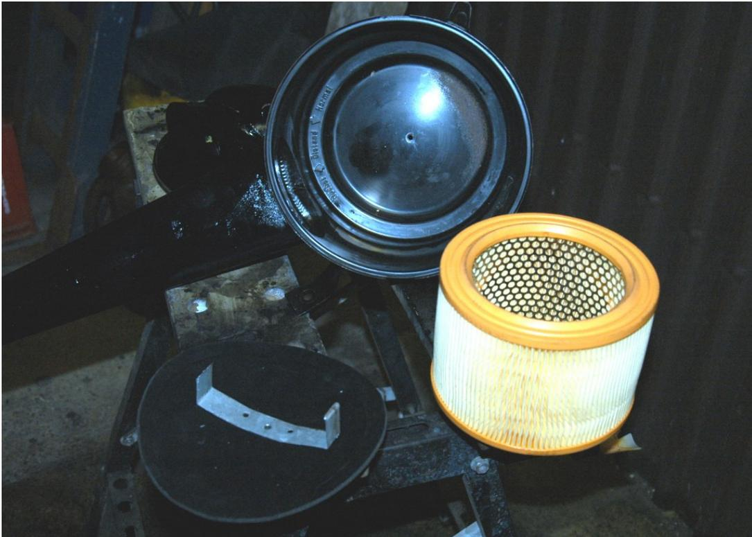
Bild 7: Bohrung und Haltewinkel
