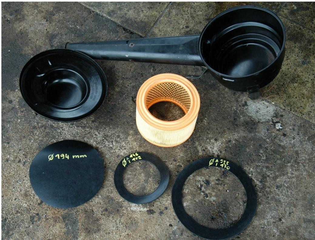
Bild 2, Teileübersicht. Nicht zu sehen: Haltewinkel, Schraube.
