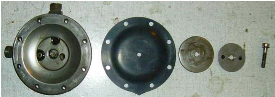
Bild: Deckel, Membran und die zwei Scheiben mit Schrauben die die Membran festhalten.
