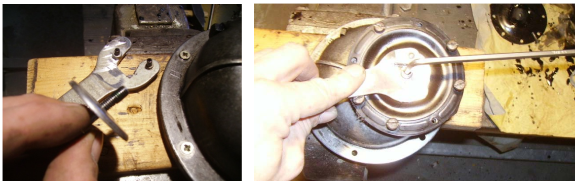
Einschrauben der neuen Membran, mit Einsatz des Stirnlochschlüssels. Die locker eingesetzten Deckelschrauben am Rand, sorgen dafür, dass die Membran sich dabei nicht verdreht.
