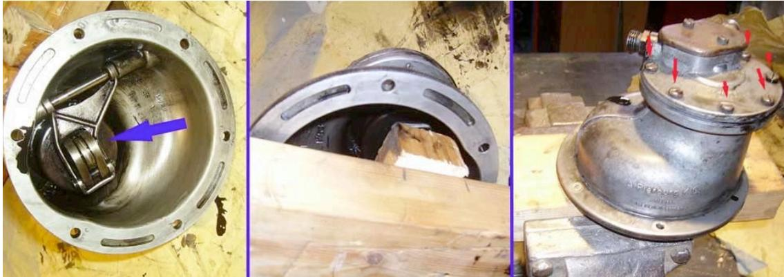
Bild: Links der blaue Pfeil zeigt den Kolben, der 12.5 mm hochgedrückt werden soll. Rechts die roten Pfeile zeigen die Verschraubung des runden Deckels, unter dem die Membran sitzt.
