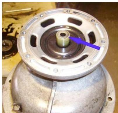
Bild links: Deckel von der Pumpe abnehmen. Bild rechts: (hier eine ausgebaute Pumpe), Pfeil zeigt auf den Kolben, der 12.5 mm nach vorne raus gucken muss .
